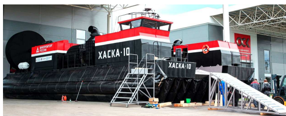
а) Судно на воздушной подушке СПВГС «Хаска-10» (Россия)
