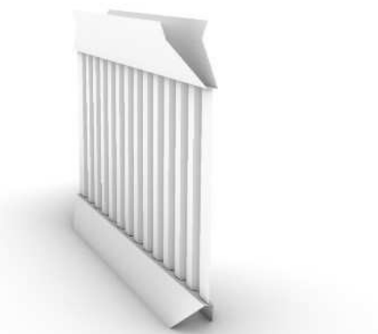
Рис. 2. Вид гофрированной поперечной переборки
