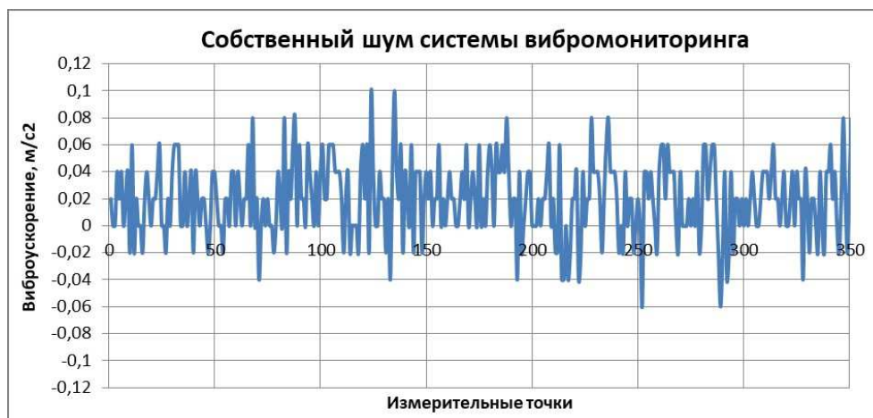
Рис. 6. Собственный шум системы вибромониторинга с датчиком, измеренный в состоянии покоя
