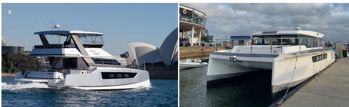
Рис. 1. Катamarаны проектов H48 (а) и SG14 (б) с бортовым остеклением большой площади и сдвижными дверями салона; оба судна сертифицированы для коммерческой перевозки 36 пассажиров по NSCV [1] 1
