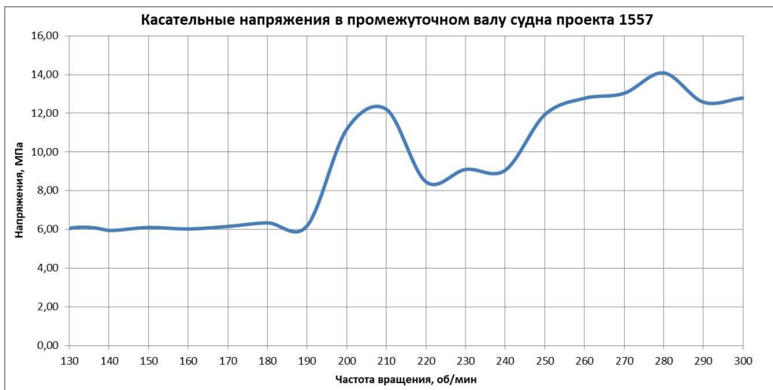
Рис. 7. График развития касательных напряжений в промежуточном валу судна проекта 1557
