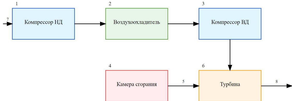
Рис. 4. Схема ГТУ со сложным циклом и промощаждением:
