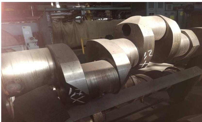
Рис 6. Определение места максимального прогиба
