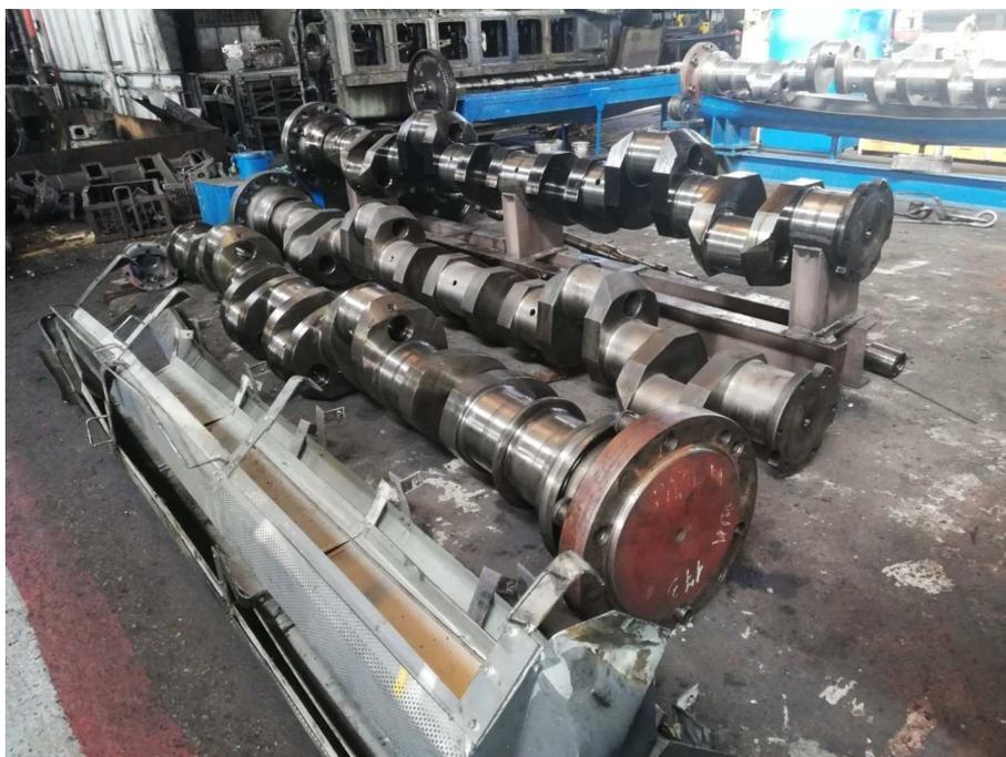
Рис 1. Коленчатый вал дизеля 6ЧН 31,8/33
