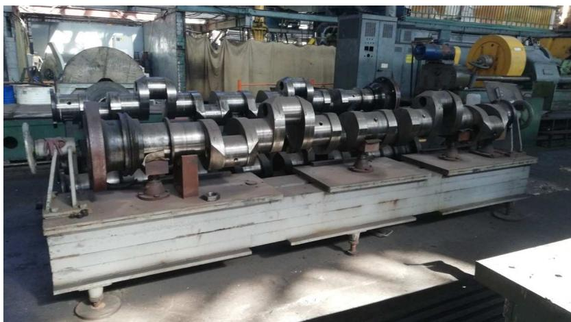
Рис 5. Стенд для правки коленчатых валов
