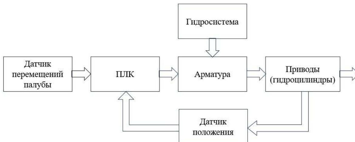
Рис. 5. Алгоритм действия системы управления Walk to Work [2]
