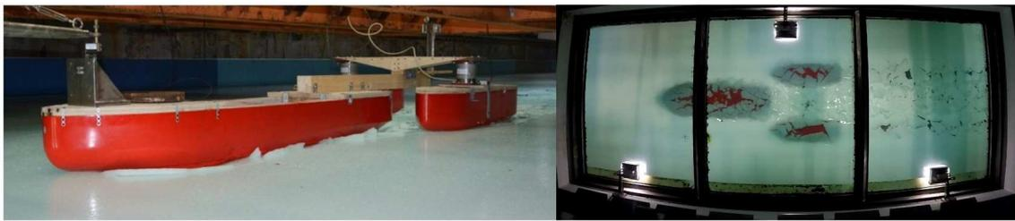
Рис. 9. Фрагменты экспериментальных исследований ледокола-тримарана в ледовом опытном бассейне ФГУП «Крыловский государственный научный центр»
