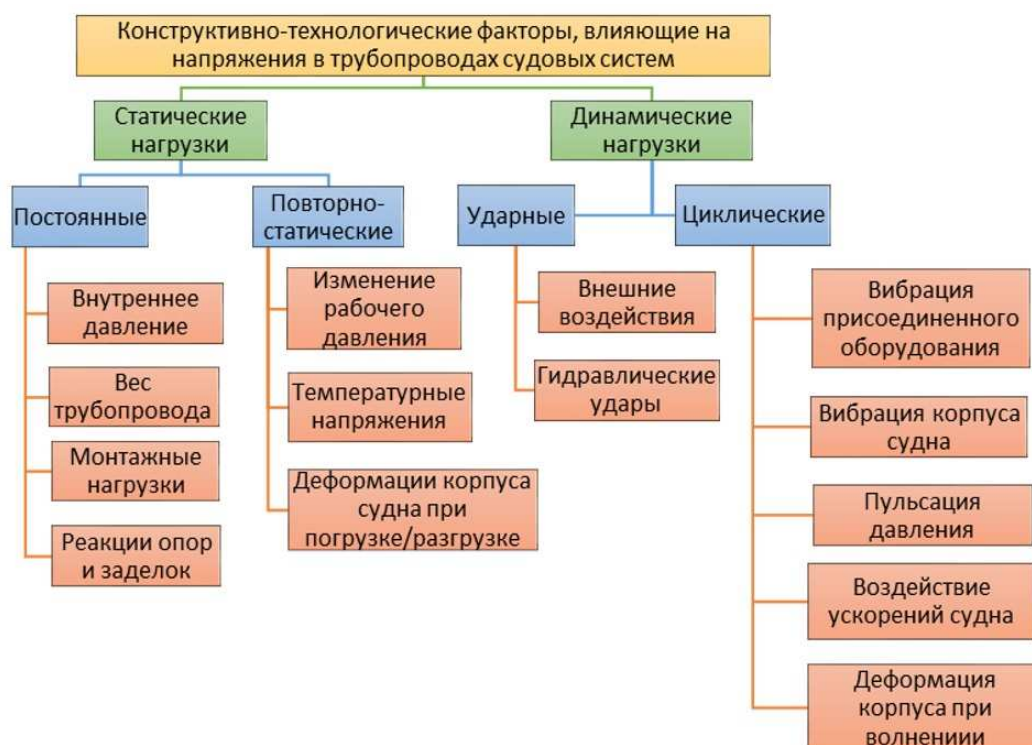
Рис. 1 Классификация нагрузок в трубопроводах судовых систем
