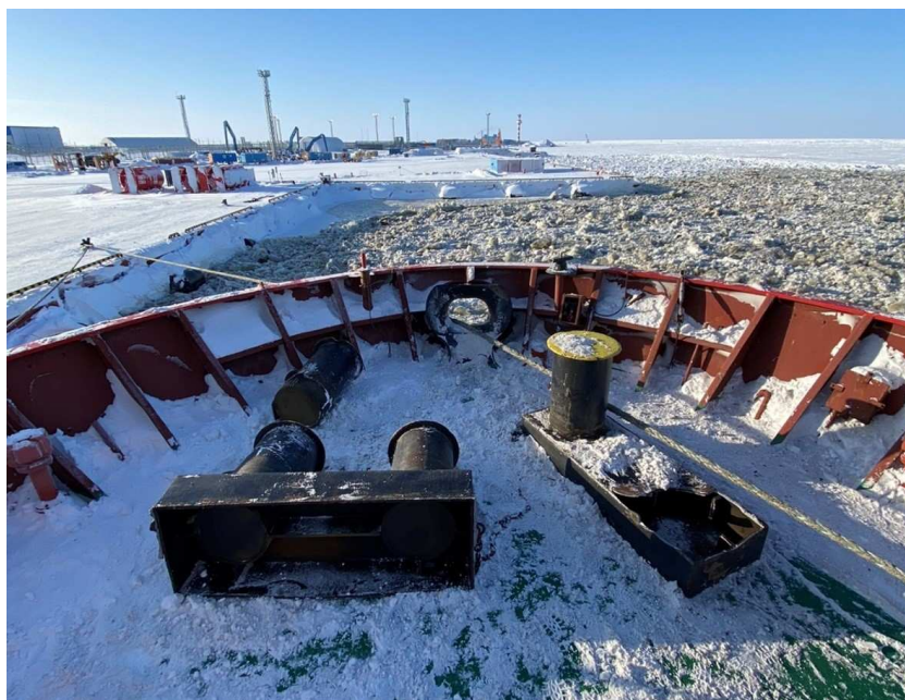
Рис. 5 Оторванные в результате буксировки «на усах» кнехты (фото: ООО «Севнор Менеджмент»)
