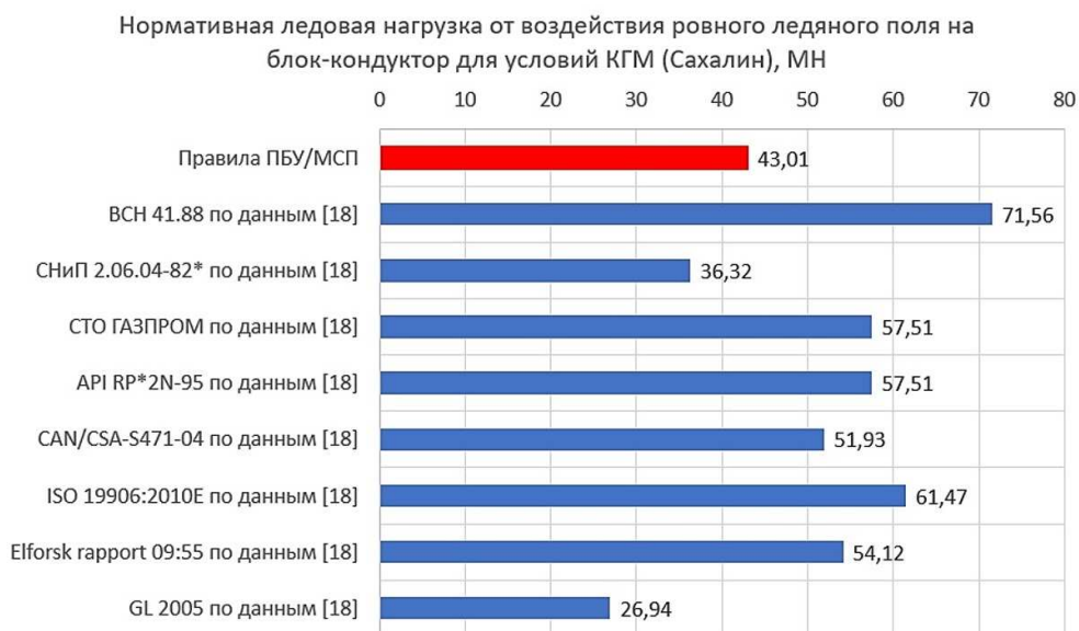
Рис. 5 Нормативная ледовая нагрузка от воздействия ровного ледяного поля на ледостойкий блок-кондуктор, диаметром 21,3 м, для условий КГМ (шельф о. Сахалин), МН
