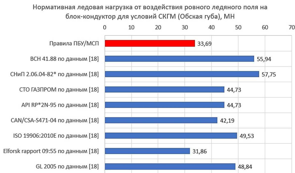
Рис. 6 Нормативная ледовая нагрузка от воздействия ровного ледяного поля на ледостойкий блок-кондуктор, диаметром 21,3 м, для условий СКГМ (Обская губа), МН
