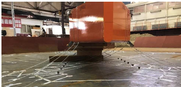
Рис. 2 Вид посуху на носовую часть модели плавучего объекта с якорными связями, размещенной на экспериментальной установке
