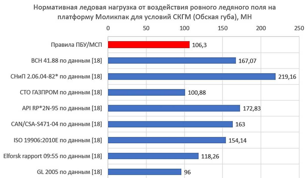
Рис. 4 Нормативная ледовая нагрузка от воздействия ровного ледяного поля на платформу Моликпак, с опорным основанием диаметром 82,3 м, для условий СКГМ (Обская губа), МН
