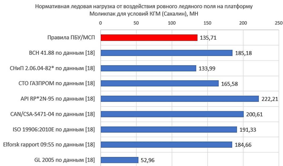
Рис. 3 Нормативная ледовая нагрузка от воздействия ровного ледяного поля на платформу Моликпак, с опорным основанием диаметром 82,3 м, для условий КГМ (шельф о. Сахалин), МН
