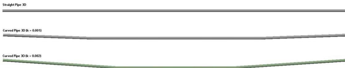
Рис. 4 Геометрические модели свободных пролетов (сверху вниз): прямолинейный, с кривизной 0,001  $\text{м}^{-1}$  и с кривизной 0,002  $\text{м}^{-1}$
