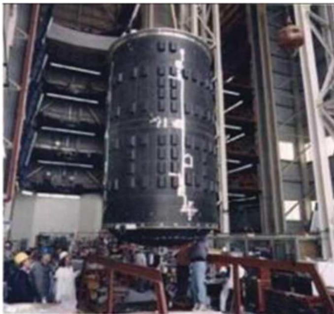
Рис. 1 Топливный резервуар DC-XA для жидкого водорода компании McDonnell Douglas (США)
