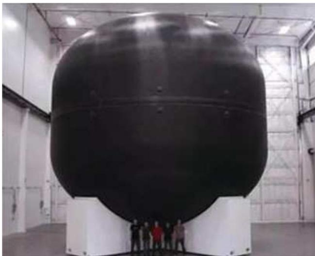
Рис. 4 Композитный криогенный резервуар компании Space X (США)
