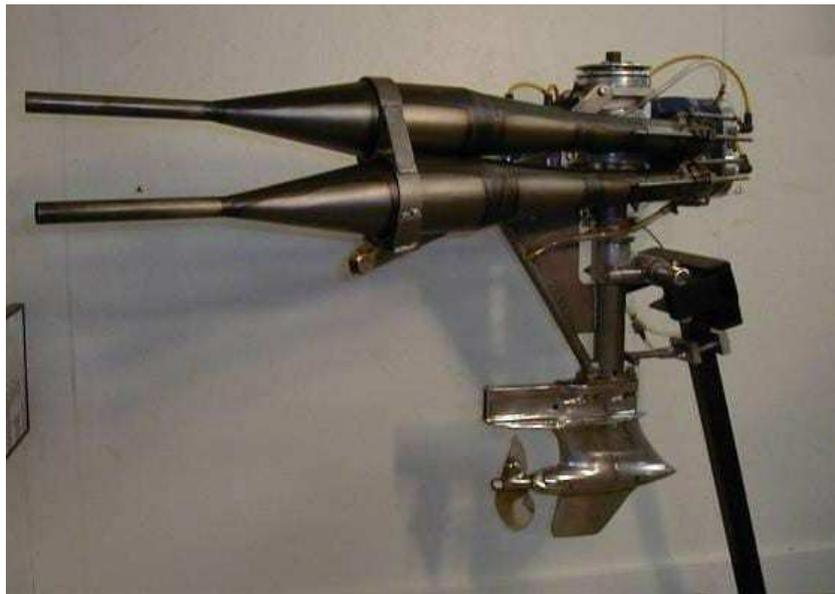
Рис. 1 Подвесной лодочный мотор с выбросом отработавших газов в атмосферу [11]
