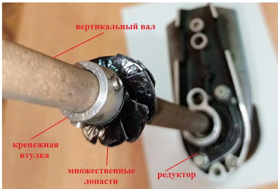
Рис. 4 Общий вид втулки с металлическими лопастями, установленной на вертикальном валу, который передает крутящий момент редуктору
