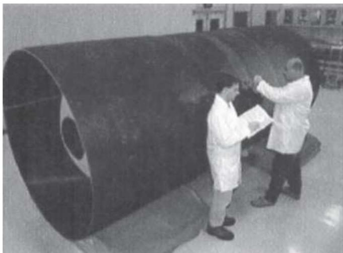
Рис. 3 Криогенный резервуар трехслойной конструкции компании Northrop Grumman (США)
