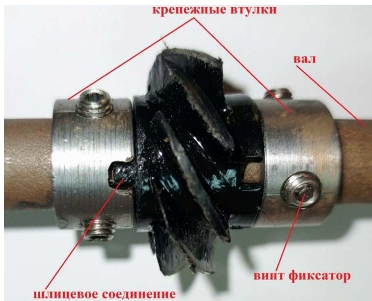
Рис. 3 Крепление множественных лопастей, обжатых с двух сторон крепежными втулками с шлицевым соединением
