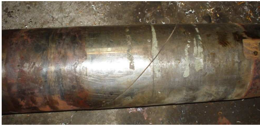
Рис. 2 Усталостная трещина, вызванная касательными напряжениями
