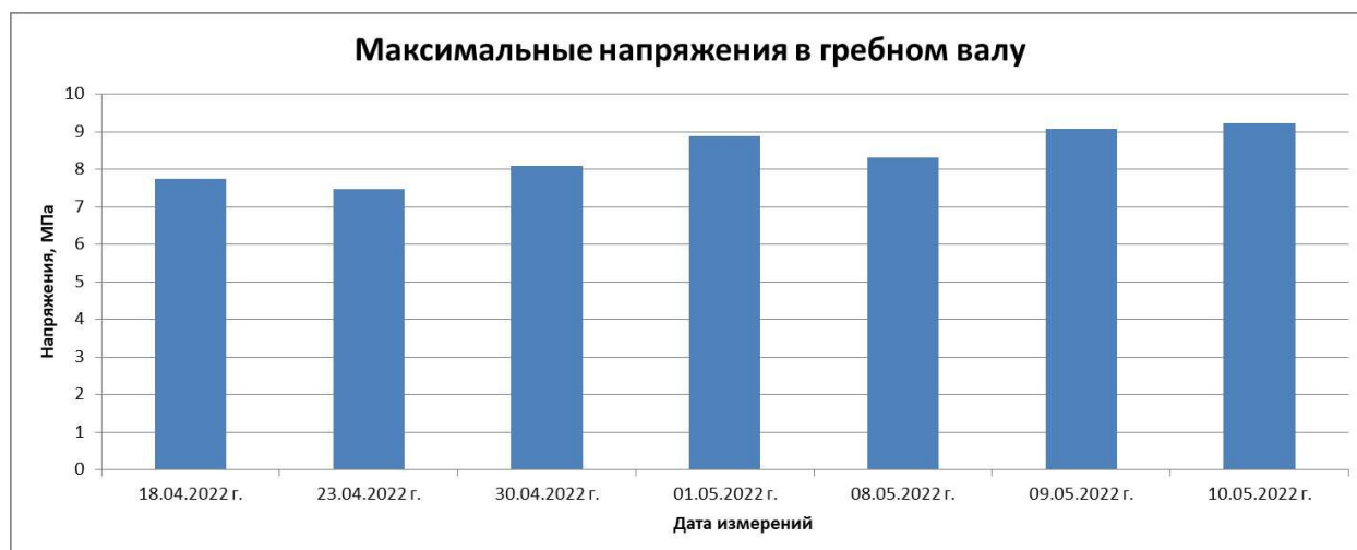
Рис. 9 Максимальные напряжения в гребном валу, зафиксированные экспериментальным образцом системы мониторинга крутильных колебаний (разработано авторами)
