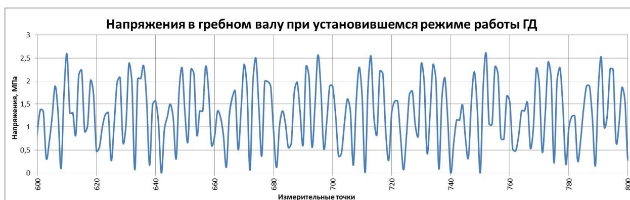
Рис. 6 Тензограмма на установившемся режиме работы ГД (разработано авторами)
