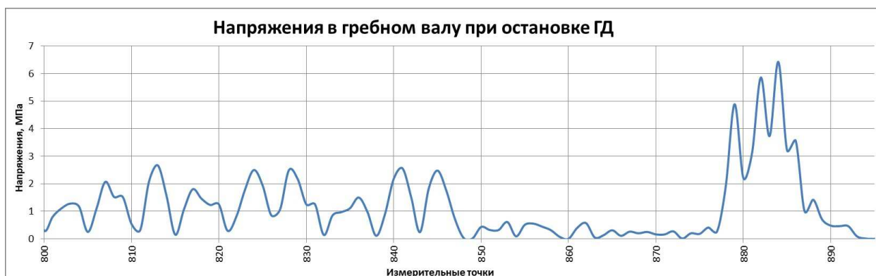
Рис. 7 Тензограмма при остановке ГД (разработано авторами)
