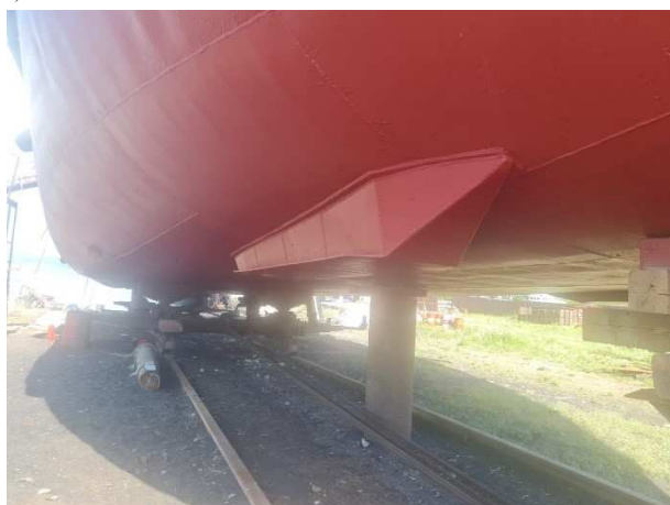
Рис. 7 Локальная ВКЗ 2023 года в носу на 10 — 16 шп. (а) и в корме на 64 — 68 шп. (б)
