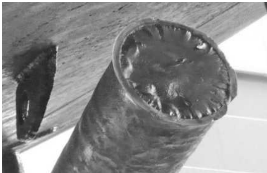
Рис. 1 Разрушение гребного вала т/х «ЭЛАНД» под действием нормальных напряжений
