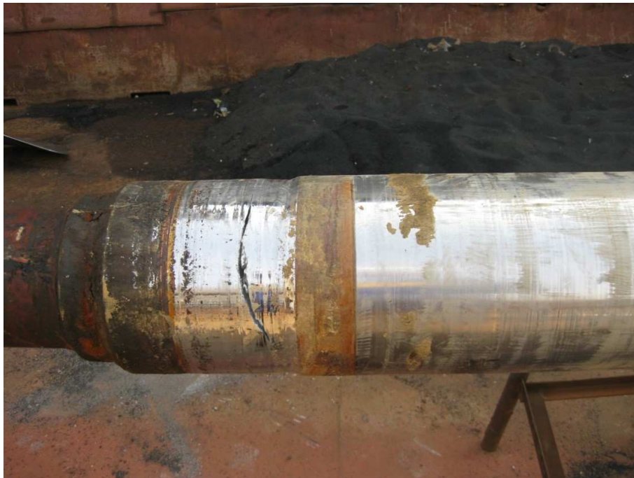
Рис. 3 Усталостная трещина, вызванная комбинацией нормальных и касательных напряжений
