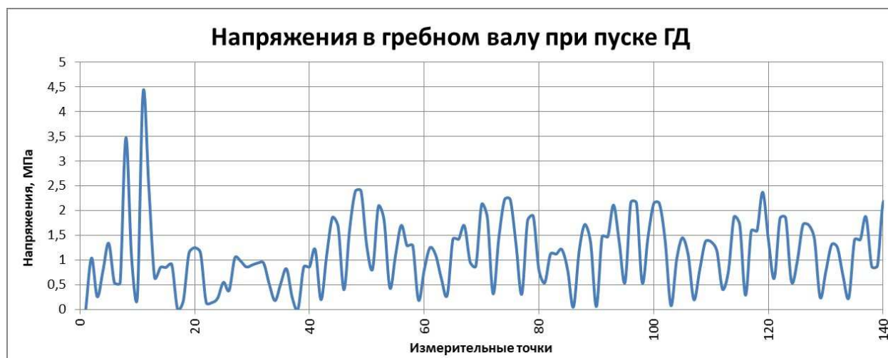
Рис. 4 Тензограмма при пуске ГД (разработано авторами)
