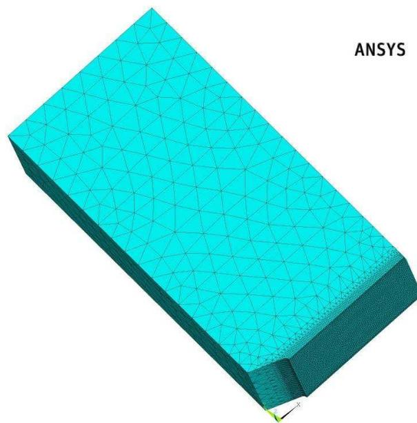
Рис. 2 Модель 1/4 образца Шарпи
