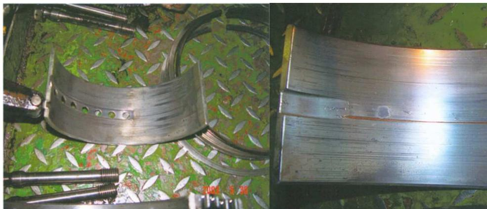
Рис. 5 Вкладыши до проведения испытаний
