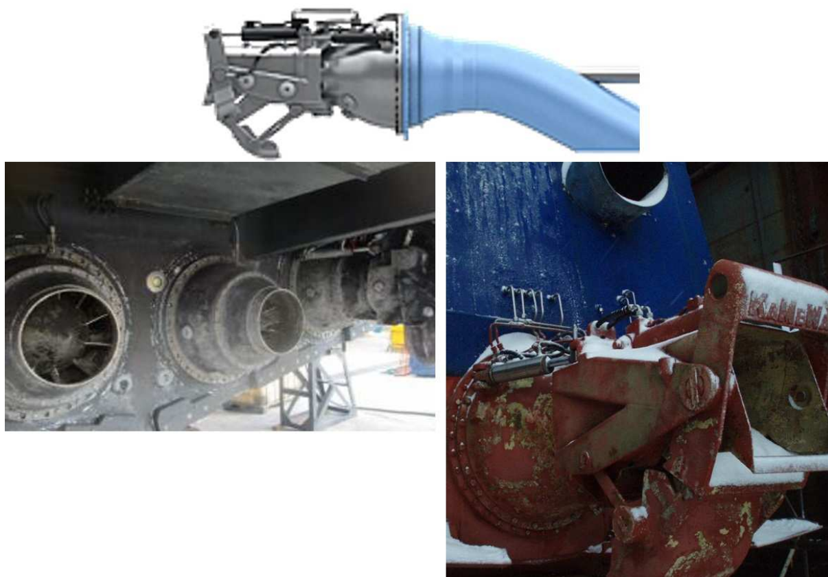
Рис. 11. Водометный движитель Kamewa S3 фирмы Rolls-Royce (вверху) 6 ; водометные движители, установленные на высокоскоростных катамаранах (внизу) 7
