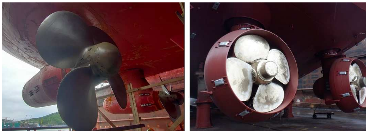
Рис. 12. Двигательнорудовые колонки в процессе освидетельствования в доке: ДРК с электродвигателем, размещенным в гондоле (слева); ДРК с механическим приводом (справа) 8
