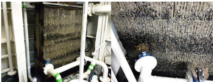
Рис. 4. Обрастание бокскулера системы охлаждения т/х «Петробалк 1» за период навигации судна в Азовском и Черном морях (фото из архива А.Э. Харламовой)
