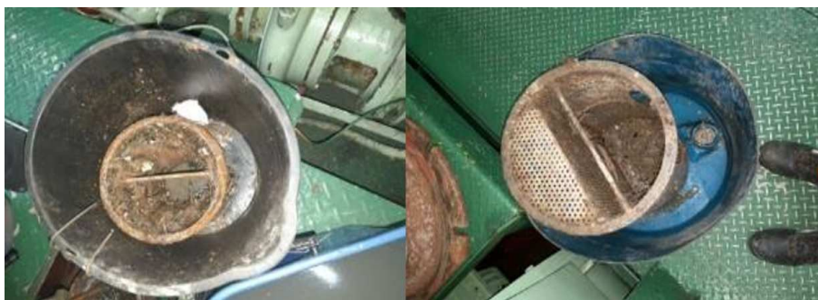
Рис. 1. Внешний вид фильтрующей ловушки дизель-генератора и главного двигателя судна снабжения платформ «Атлантик Суппортер» (фото из архива механика судна И.Р. Муханова)
