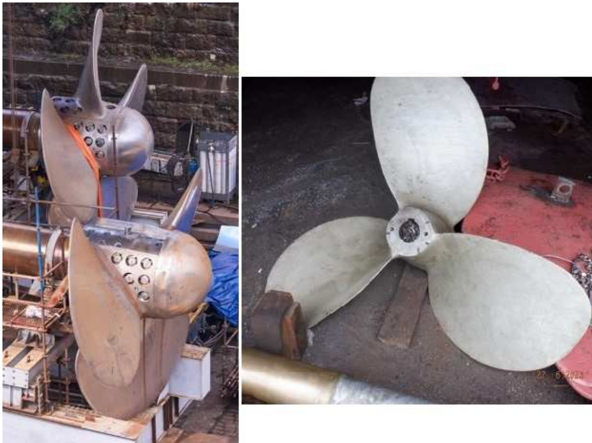
Рис. 6. Винты фиксированного шага со съёмными лопастями (слева) и цельнолитой (справа) в процессе освидетельствования 1
