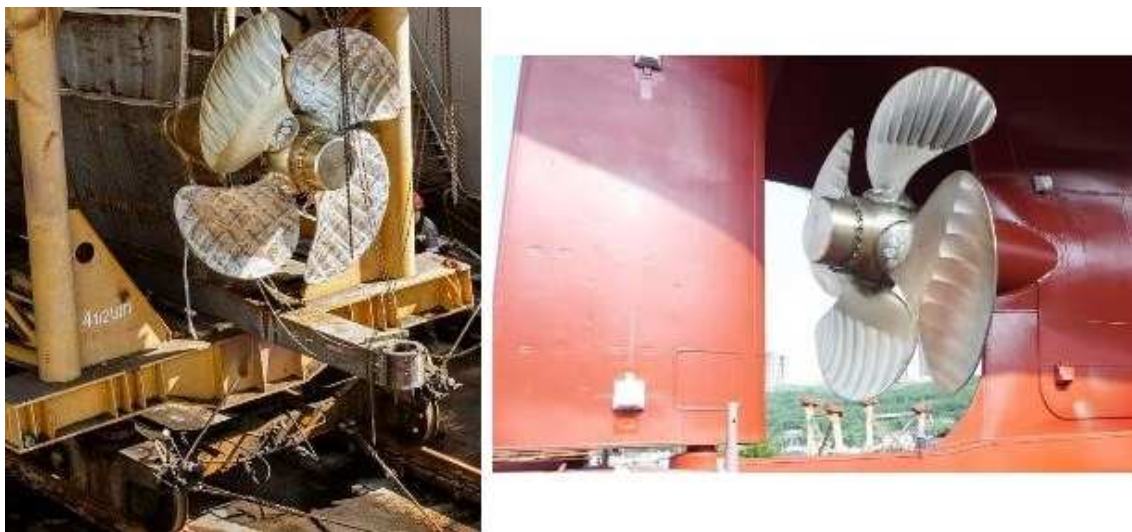
Рис. 7. Винт регулируемого шага на судне-крановом в процессе монтажа (слева) и при освидетельствовании перед спуском судна (справа) 2
