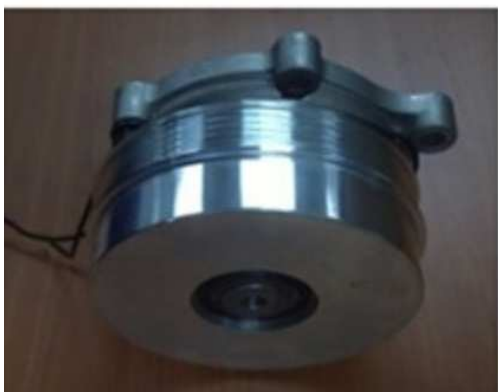
Рис. 6. Насосы с электромагнитной муфтой (а) и насос с двухскоростным планетарным редуктором (б)
