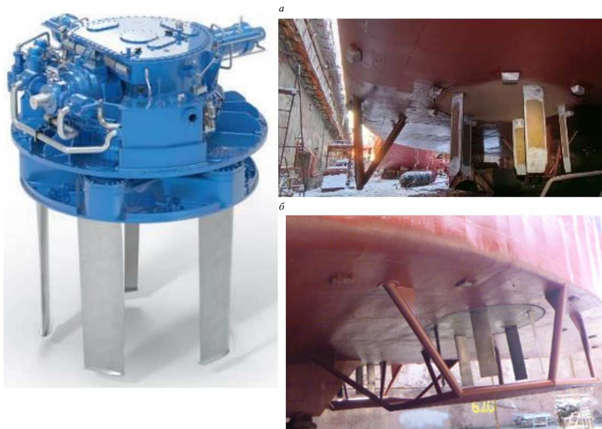
Рис. 9. Крыльчатый движитель, предлагаемый компанией Voith Group, Германия (слева) 3 ; расположение крыльчатых движителей и защитные устройства на плавкране (а) и земснаряде/грунтовозном судне (б) (справа) 4
