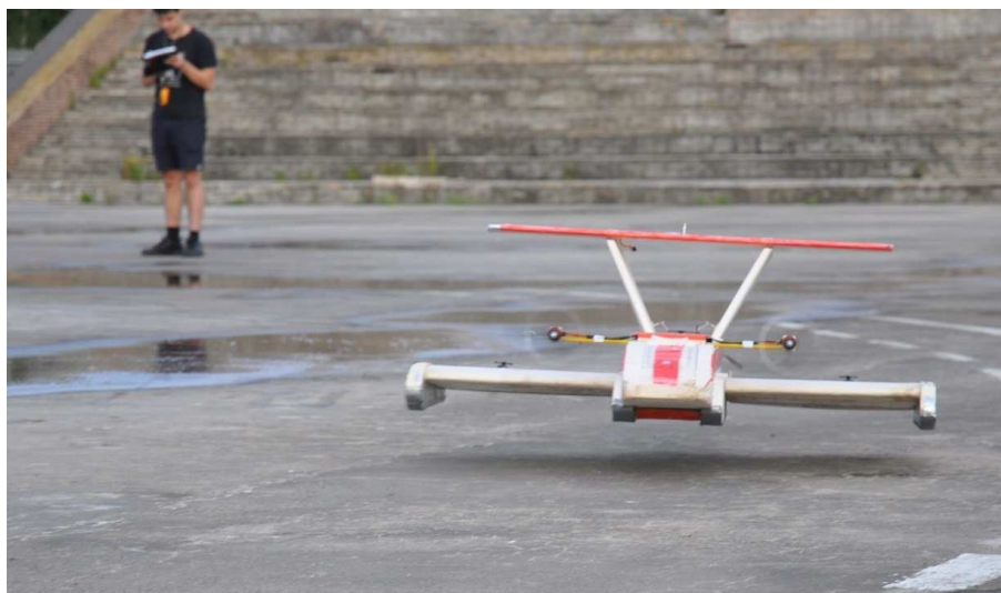
Рис. 6. Радиоуправляемая модель экраноплана с шасси на воздушной подушке
