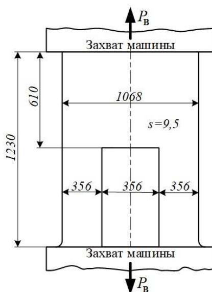
Рис. 6. Схема испытания на разрыв пластины с прямоугольным вырезом [11]
