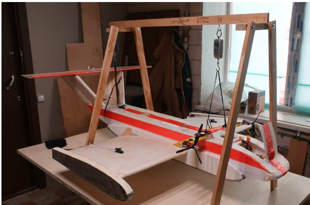
Рис. 8. Устройство для замеров массы, центровки и тяги экраноплана
