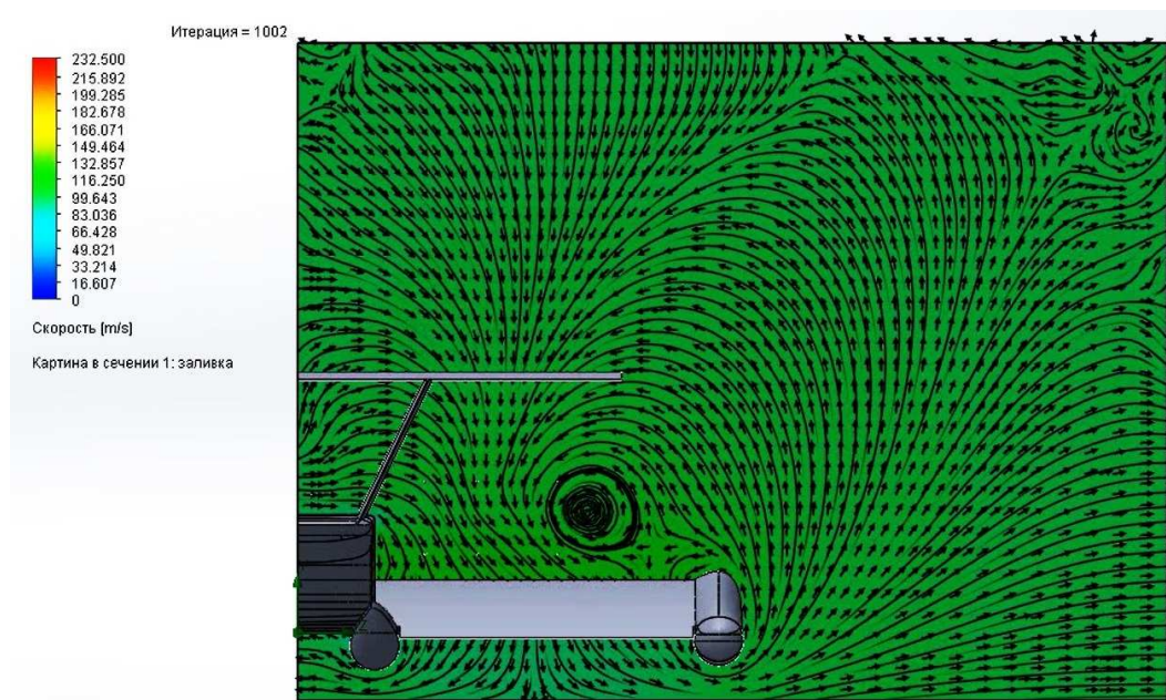
Рис. 13. Вид сзади на экраноплан при оценке образования завихрений от гондол двигателей
