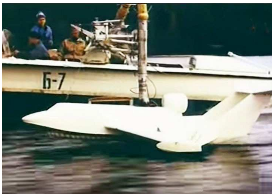
Рис. 3. Буксировка модели за скоростным катером на штанге 2
