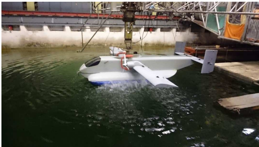
Рис. 2. Модель самолета с шасси на воздушной подушке в опытном бассейне
