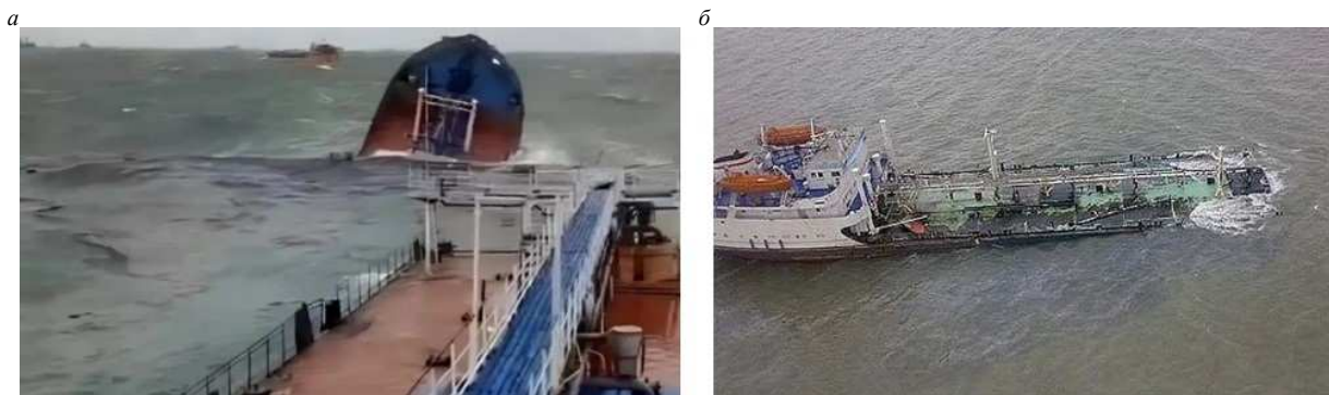
Рис. 1. Перелом корпуса танкера «Волгонефть»: а — момент аварии; б — оставшаяся часть корпуса
