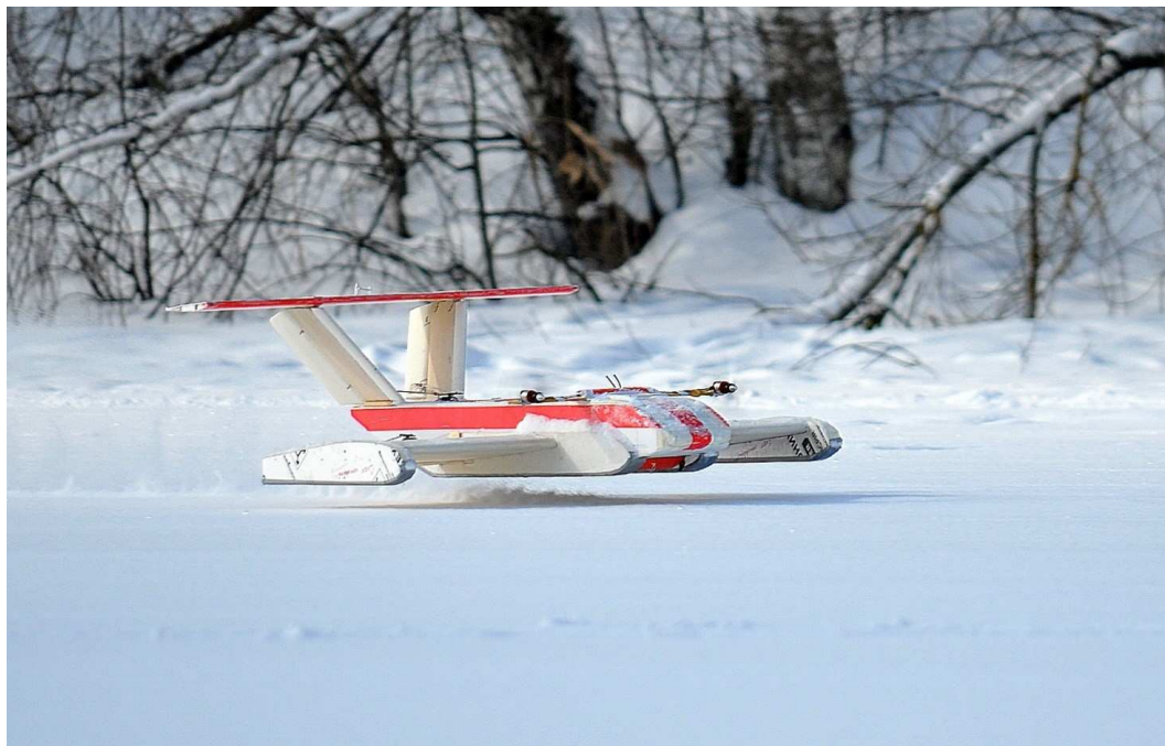
Рис. 10. Полет модели на экране с работающим вентилятором
