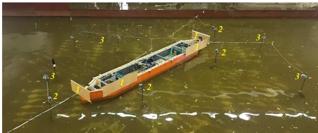
Рис. 5. Модель плавучего объекта с экранами, отражающими ультразвуковые сигналы от УЗД, расположенными перед носовой и кормовой частями объекта, а также по его борту: 1 — отражающие экраны; 2 — УЗД для подачи сигналов в горизонтальной плоскости; 3 — УЗД для подачи сигналов в вертикальной плоскости
