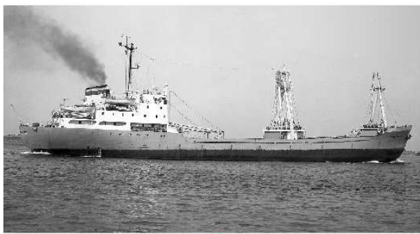
Рис 5. Отечественные суда Проект 580, тип «Павлин Виноградов», использовавшие СПГТ GS34 и отечественную силовую турбину в качестве главного двигателя [29]
