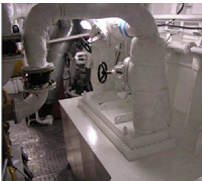
Рис. 5. Расположение забортного охладителя проточного типа в машинном отделении буксира «CASTOR» (слева) и расположение теплообменного аппарата в выгородке теплообменного ящика (справа) по материалам фирмы BLOXMA
