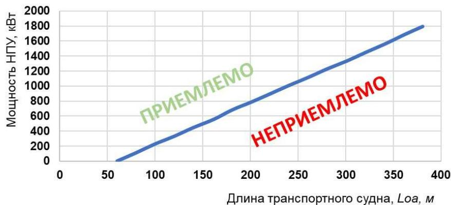
Рис. 3. Алгоритм определения параметра «наличие ПУ» транспортного судна для определения необходимого количества буксиров и их мощности в порту Дарвин (Австралия)
