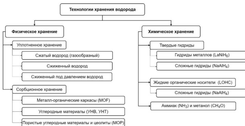
Рис. 1. Основные технологии хранения водорода
