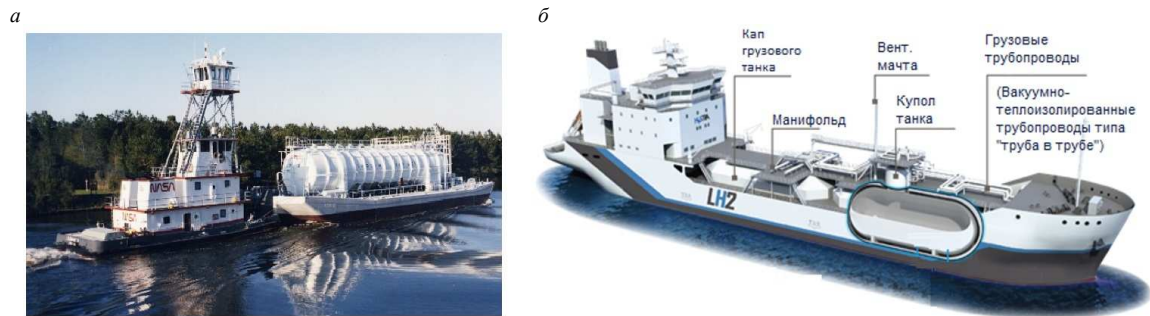
Рис. 8. Буксир Clermont II доставляет жидкий водород через систему каналов в космическом центре NASA «Стеннис» (а); газозов для транспортировки сжиженного водорода Suiso Frontier (б)
