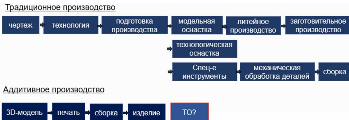
Рис. 2. Сравнение технологических цепочек изготовления деталей традиционным и аддитивным методами
