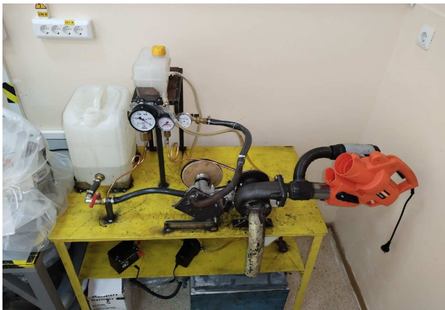
Рис. 17. Стенд с турбонасосом системы охлаждения
