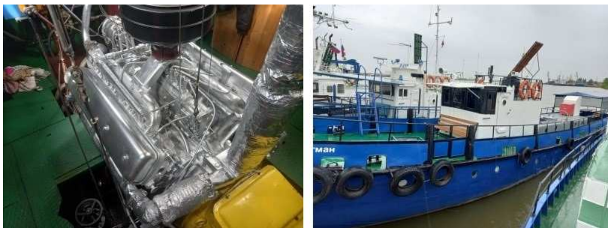
Рис. 3. Судно «Флагман» с главным двигателем 8ЧНСП13/14
