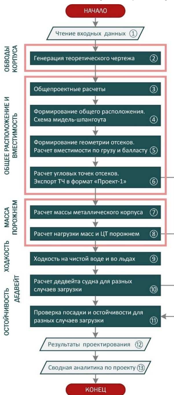
Рис. 1. Общая схема вычислительного процесса ЦД проекта судна
