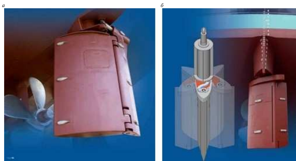
Рис. 1. Рули изменяемого профиля с закрылком: а — руль Becker; б — руль Herackles
