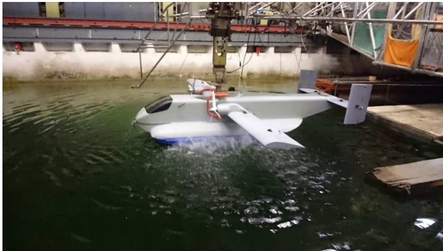
Рис. 2. Модель самолета с шасси на воздушной подушке в опытовом бассейне
