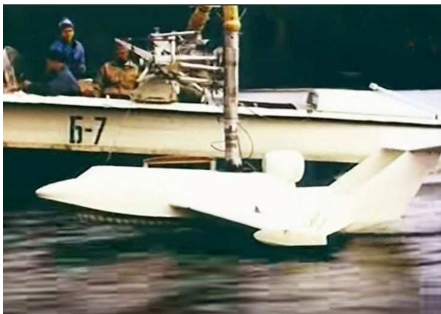
Рис. 3. Буксировка модели за скоростным катером на штанге 2
