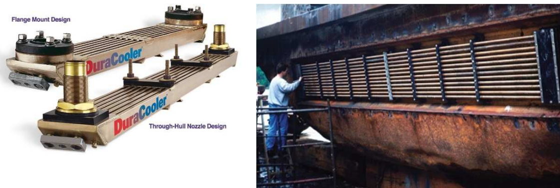
Рис. 6. Килевые забортные охладители фирмы Duramax Marine: забортные аппараты (слева) и пучки труб (справа)
