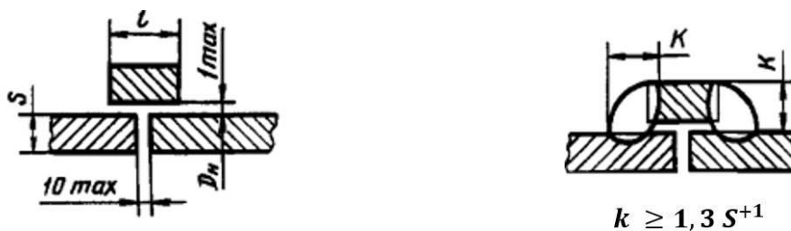
Рис. 5 Требование к размерам муфтового соединения согласно ОСТ 5Р.9089-92 [3]
