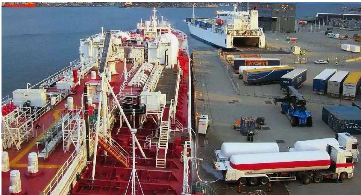
Рис. 2. Отсутствие ограждения зоны безопасности (safety zone)
