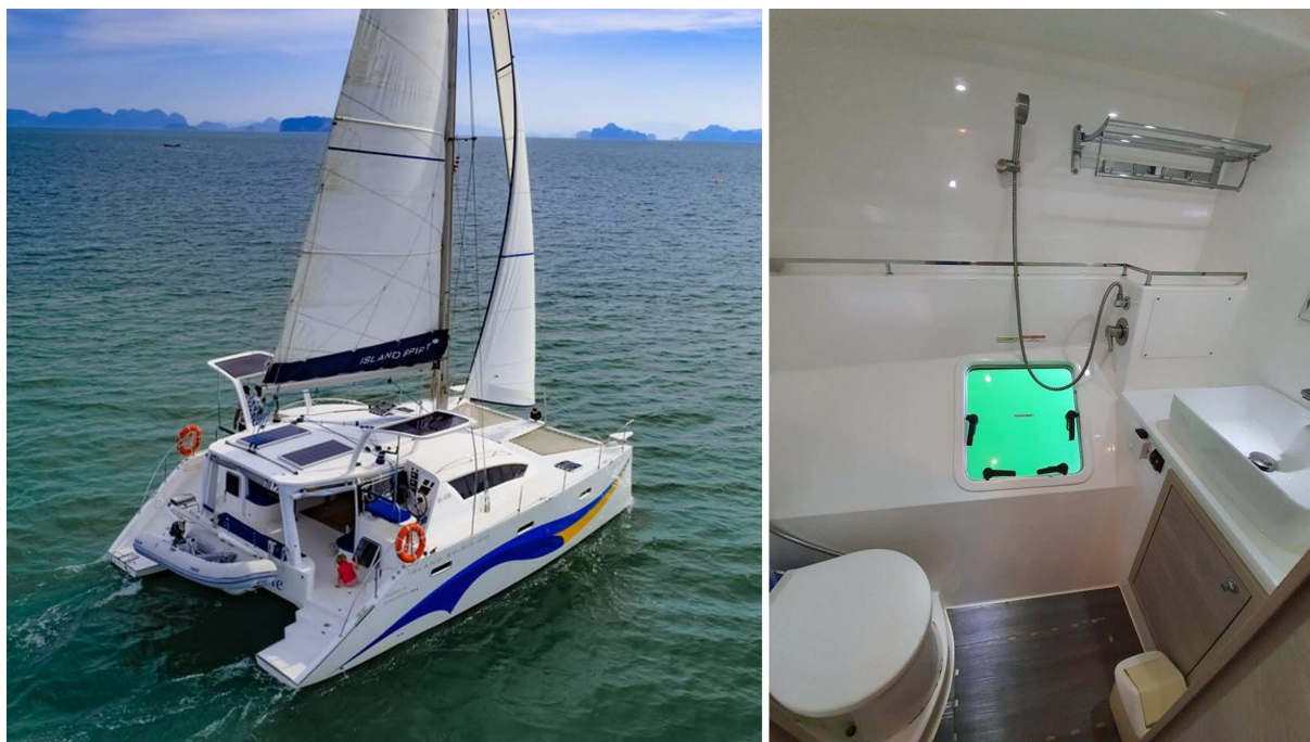
Рис. 4. Эвакуационный люк категории водонепроницаемости 1 по ISO 12216 на катамаране IS410, установлен в помещении санузла. Судно серийное, имеет сертификат CE на категорию А (8 человек), а на категории С и D — на 28 человек на борту
